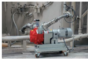
usurare rapidamente le componenti interne; inoltre il pompaggio di smalti richiede capacità di gestire fluidi altamente viscosi e, al tempo stesso, delicatezza nella movimentazione. Le pompe a lobi rotativi Vogelsang sono la giusta risposta: autoadescenti, possono regolare con precisione la portata e invertire il senso del flusso. Sono inoltre altamente resistenti ai materiali abrasivi e grazie al sistema QuickService le parti usurate si cambiano in sede e in breve tempo.
