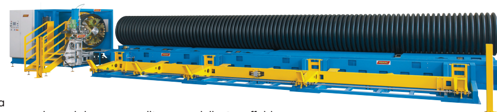
Impianto automatico in linea per la giunzione a riporto del tubo corrugato in PE-PP
