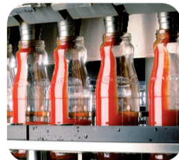
Particolare della linea di riempimento vasi e bottiglie. Le linee del reparto vetro di CO.PAD.OR. possono confezionare sino a 1.000.000 unità/giorno
